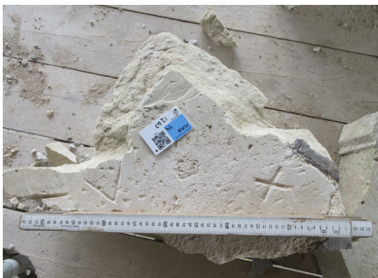
2) Bovenzijde van een blok Ledesteen met links het plaatsingsmerk 5 (V) en rechts een steenhouwersmerk (X). (foto Hein Hundertmark 2022)
