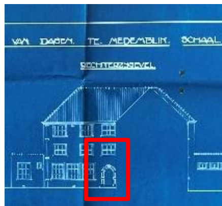
afbeelding 68 Detail van slooptekening en ontwerptekening 1930. In het rode kader de positie van de herplaatste poort in de westgevel van de aanbouw. (WfA, 2022)
