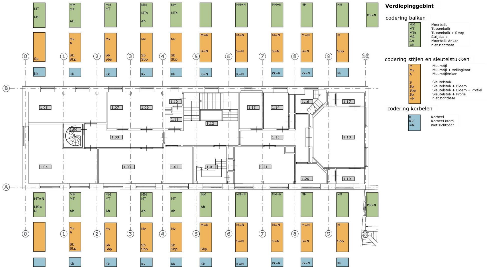
afbeelding 152 Plattegrond verdieping 2022. De draagconstructie van de ZOLDERVLOER. In kleur en lettercodes rechts van de betreffende as in de travee travee. Noord en zuid zijn aangegeven respectievelijk boven en onder de plattegrond.
