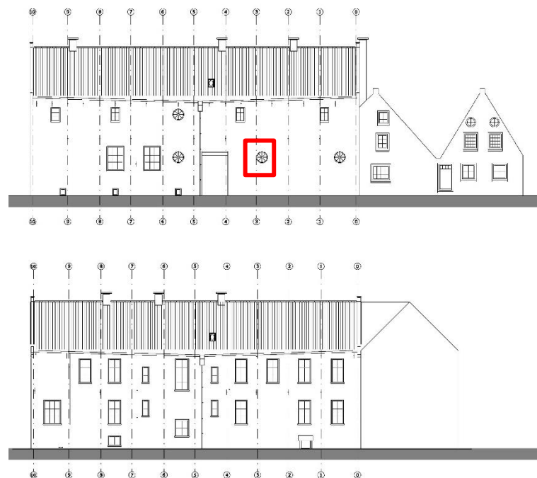
afbeelding 100 Noordgevel 2022. Boven: reconstructie vóór verbouwing op basis van foto uit 1923. Rechts de tuitgevels van de aanbouwen uit 1647. Onder: reconstructie na verbouwing met rechts de aanbouw uit 1930. In het rode kader de positie van een bouwspoor van een dichtgemetseld rond venster zie foto N4 1990.
