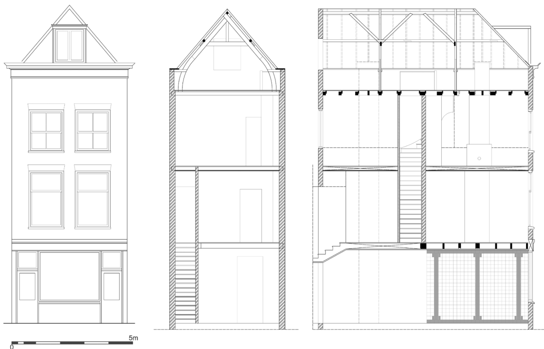
5) Doorsnede- tekeningen en voorgevel van het voorhuis. Situatie vlak voor de sloop in 2020. (tekening P.J. Bosman)
