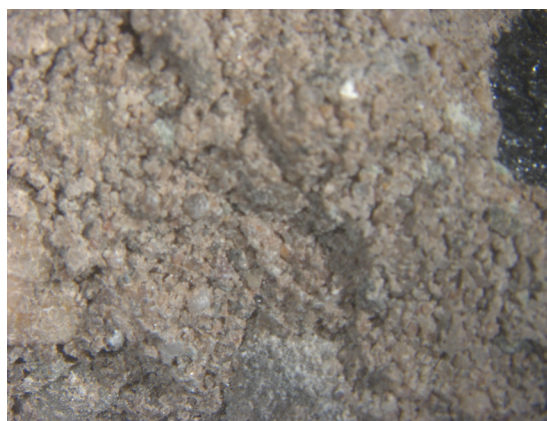
5) Links in het werk gestorte kolom, monster 7, rechts prefab beton, monster 2. (TNO 2020)
