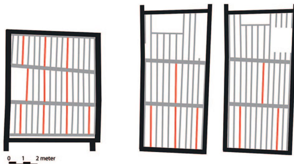
17 Kruisstraat 12–14 und Hinthamerstraat 138, Schema der Balkenlagen. Die Positionen der Kinderbalken mit Schwalbenschwanzblatt im Haus Kruisstraat 12–14 (1471 d) zeigen über die gesamte Hausbreite durchgehende, aneinander anschließende Verläufe (links), während im Haus Hinthamerstraat 138 (1546 d) auf eine durchlaufende Verwendung der Schwalbenschwanz-Kinderbalken verzichtet wurde (Mitte und rechts).
