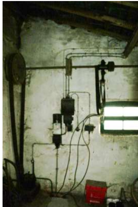
Figuur 185: Electromotor (links beneden), aandrijfas met wielen en riemen en boterkarnmachine (rechts) in bouwdeel 4b.
