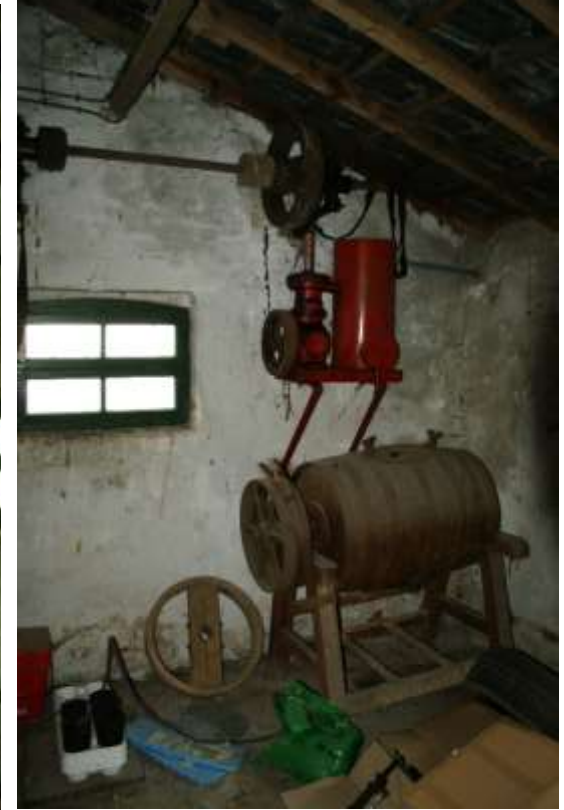
Figuur 185: Electromotor (links beneden), aandrijfas met wielen en riemen en boterkarnmachine (rechts) in bouwdeel 4b.
