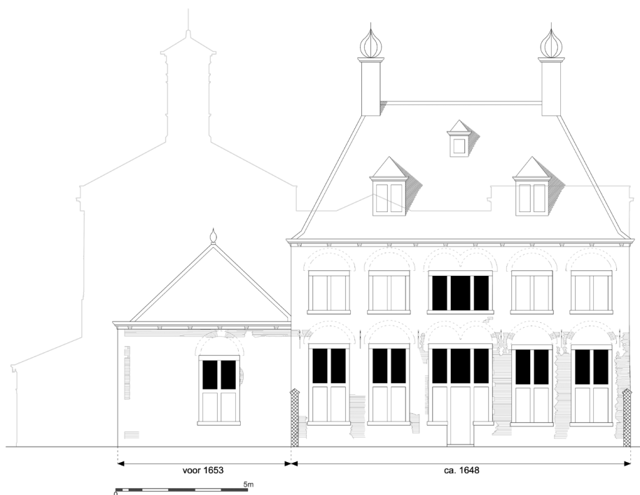
Reconstructie van de zeventiende-eeuwse situatie met daarin de gevonden bouwsporen. (tekening P.J. Bosman)
