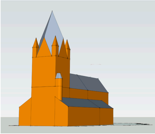
Afb. 13 Impressie van de torenbekroning van de Stevenskerk in Nijmegen, zoals die omstreeks 1310 was voltooid. Kenmerkend zijn de topgevels en de hoektorentjes. Deze vorm kan worden herleid uit een beschrijving die omstreeks 1465 is genoteerd. (afb. K. Emmens)
