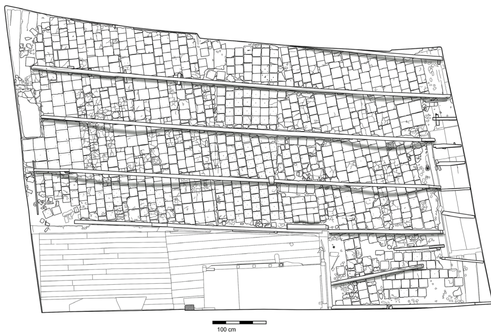
Afb. 5 Digitale weergave van de 16de-eeuwse plavuizenvloer met daarin aangegeven de 17de-eeuwse aanpassingen. In het midden geeft de schuine strook de later aangelegde gang aan. (bewerking en afbeelding: Nipides 2015)
