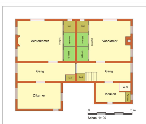
Afb. 22: Plattegrond van het in 1751 gebouwde dubbele commandeurshuis, Herenweg, Hollum op Ameland, nu in gebruik als Museum Sorgdrager. (tekening auteur)
