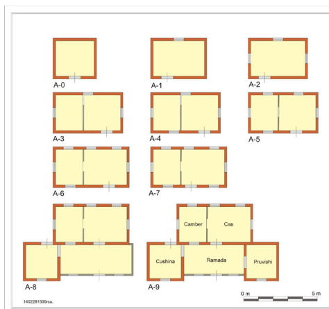
Afb. 9: Overzicht van de ontwikkeling van de cas di piedra van één kamer tot een tweebeukige variant. (tekening auteur op basis van Bonarese woonhuizen)
