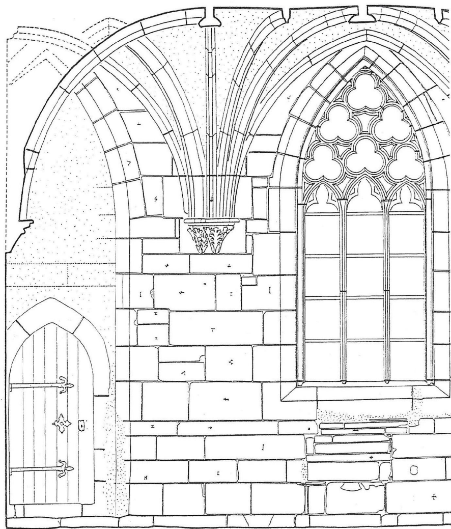
Afb. 6 Nauwkeurigheidsrap IV. Maulbronn, klooster, kapittelzaal, dwarsdoorsnede. Detail van de fotogrammetrische opmeting (uit: G. Eckstein, Empfehlungen für Baudokumentationen (Stuttgart 1999).
