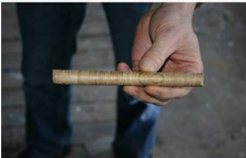
Het verwijderen van een zojuist geboord monster uit een balk.
