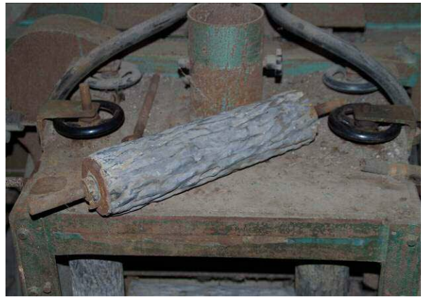
Afb. 13: Walsrol met boomschorspatroon in de voormalige steenfabriek aan de Nielsestraat te Boom-Noeveren
